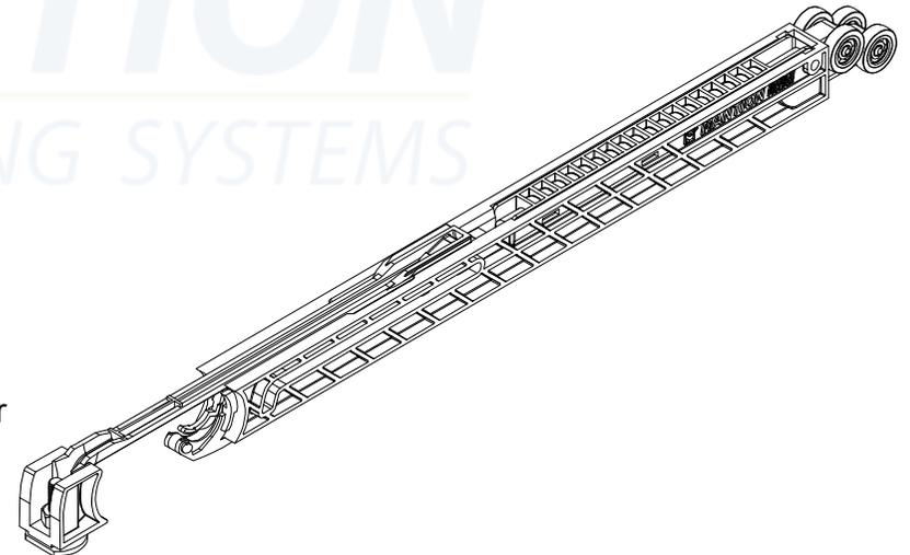
Ferme porte, pour panneaux de 130 à 180 lbs [60 à 80 Kg] MAX + clé
