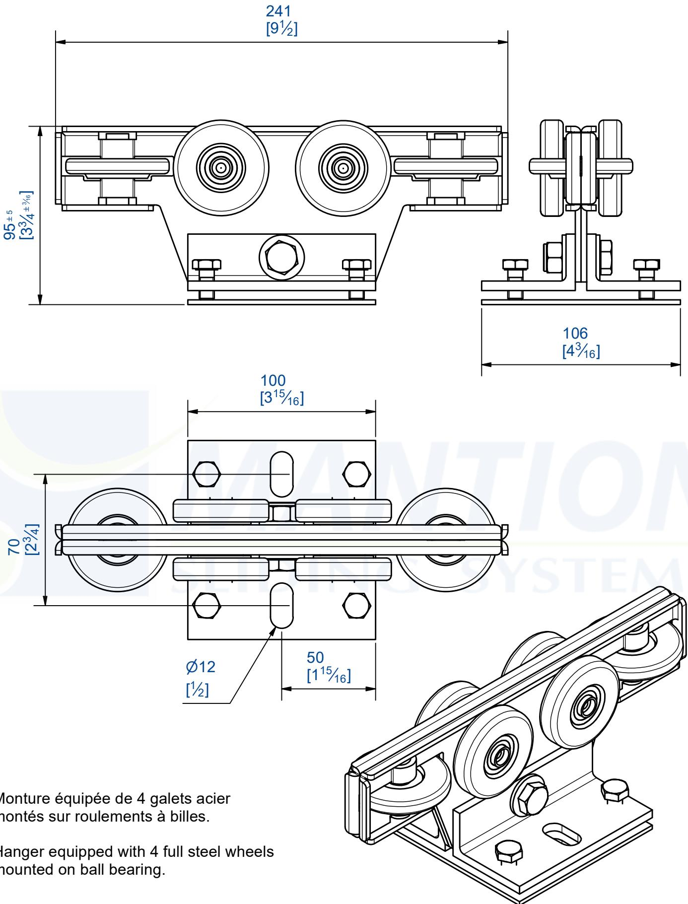
Monture équipée de 4 galets acier montés sur roulements à billes.
