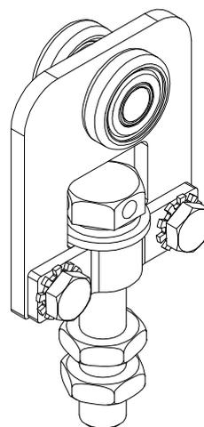
Monture pivotable d'extrémité
