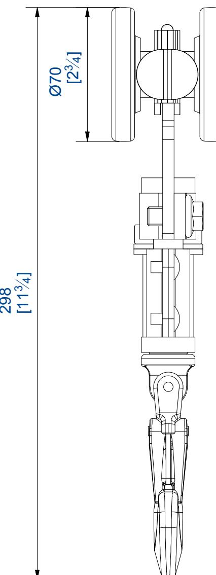
Chariot double à crochet équipé de galets à roulement à billes et surmoulage Nylon chargé billes de verre
