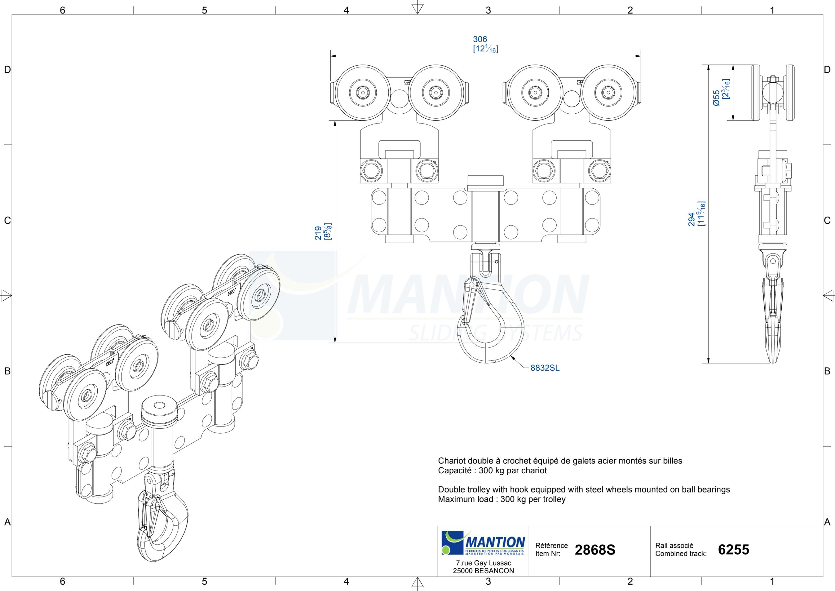
Chariot double à crochet équipé de galets acier montés sur billes
