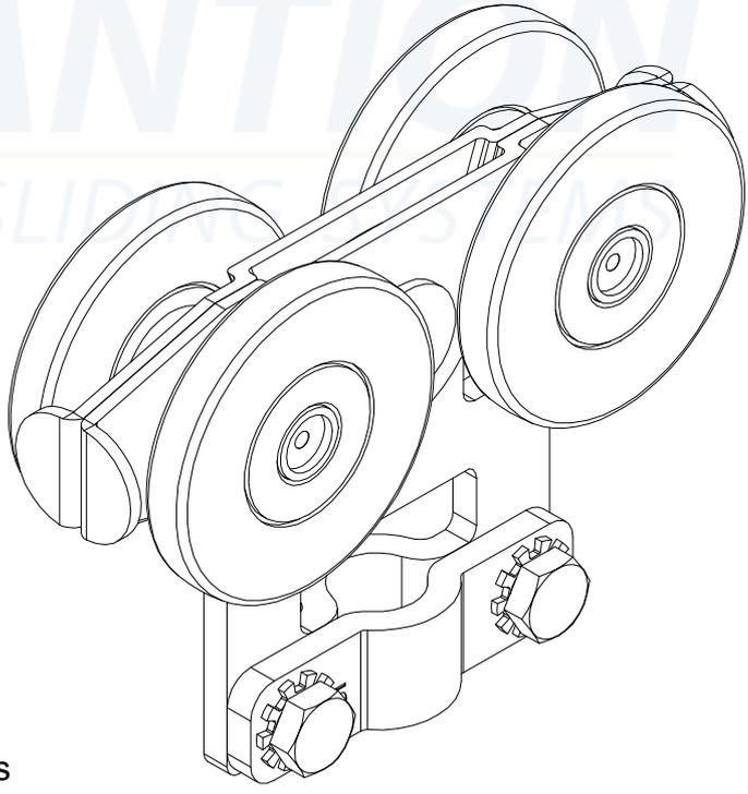
Chariot équipée de 4 galets acier monté sur billes
