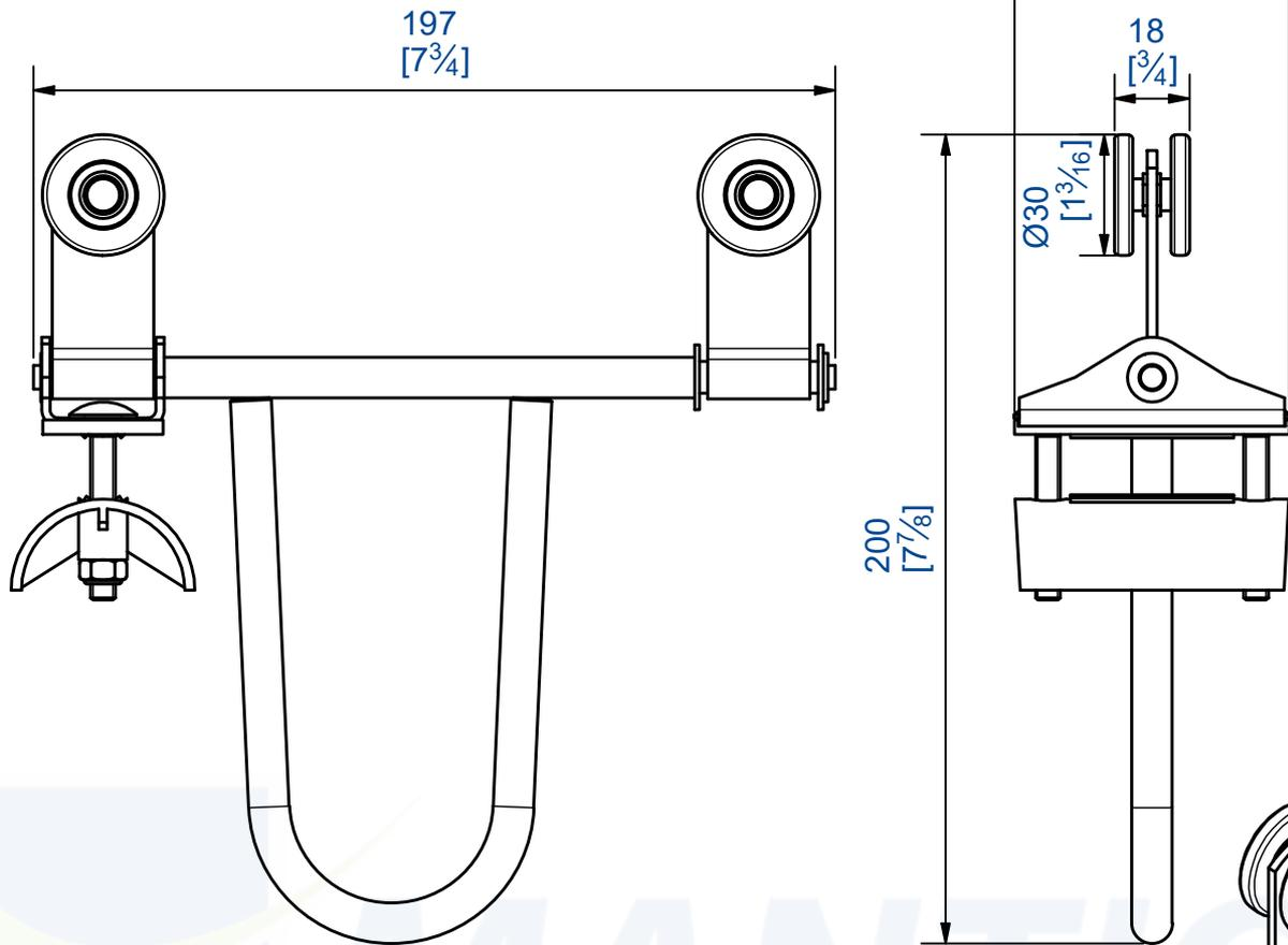
Chariot d'entraînement équipé de galets nylon montés sur roulements à billes - câble 45 x 20 max.
