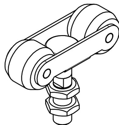
Monture pivotante avec 2 galets nylon.
