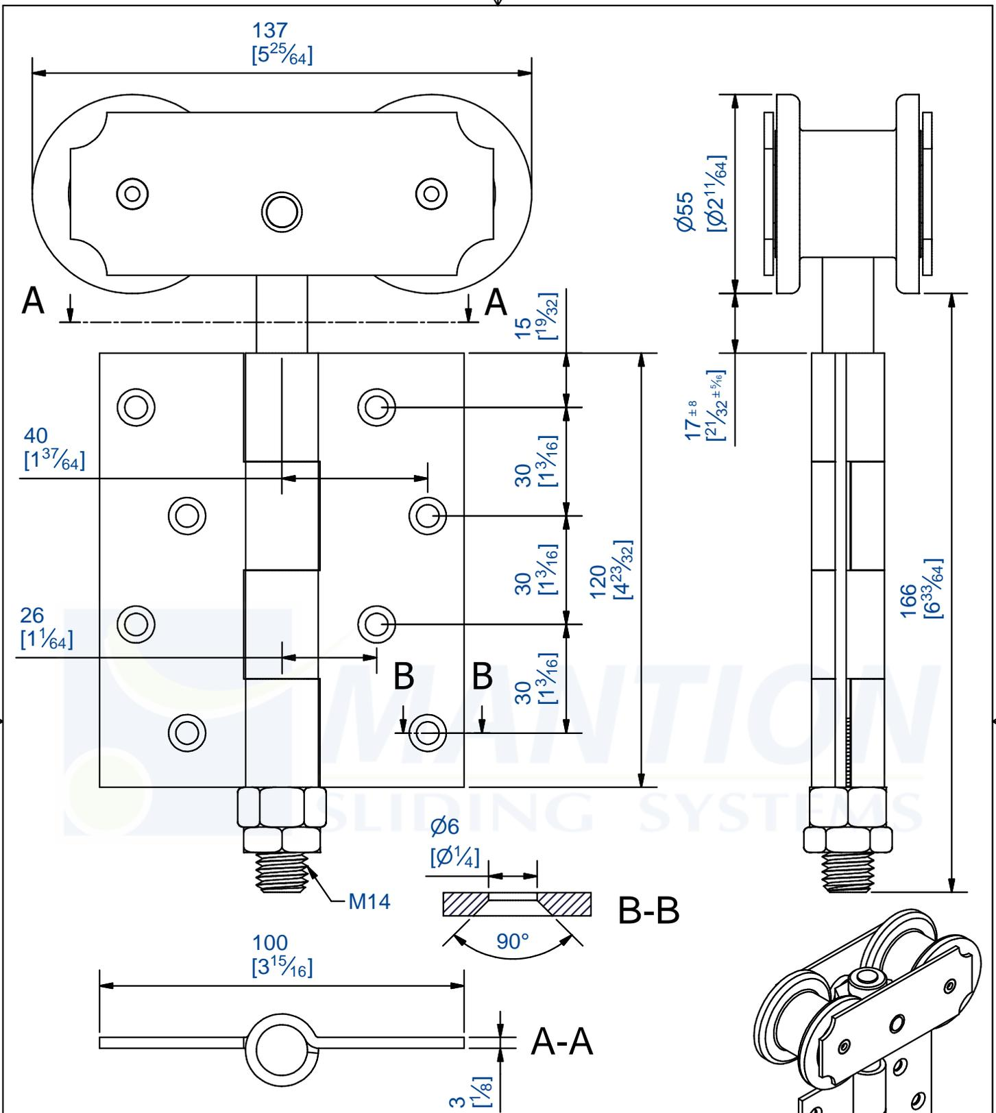
Monture intermédiaire, équipée d'une charnière sur plat avec 2 galets acier sur cages à rouleaux.
