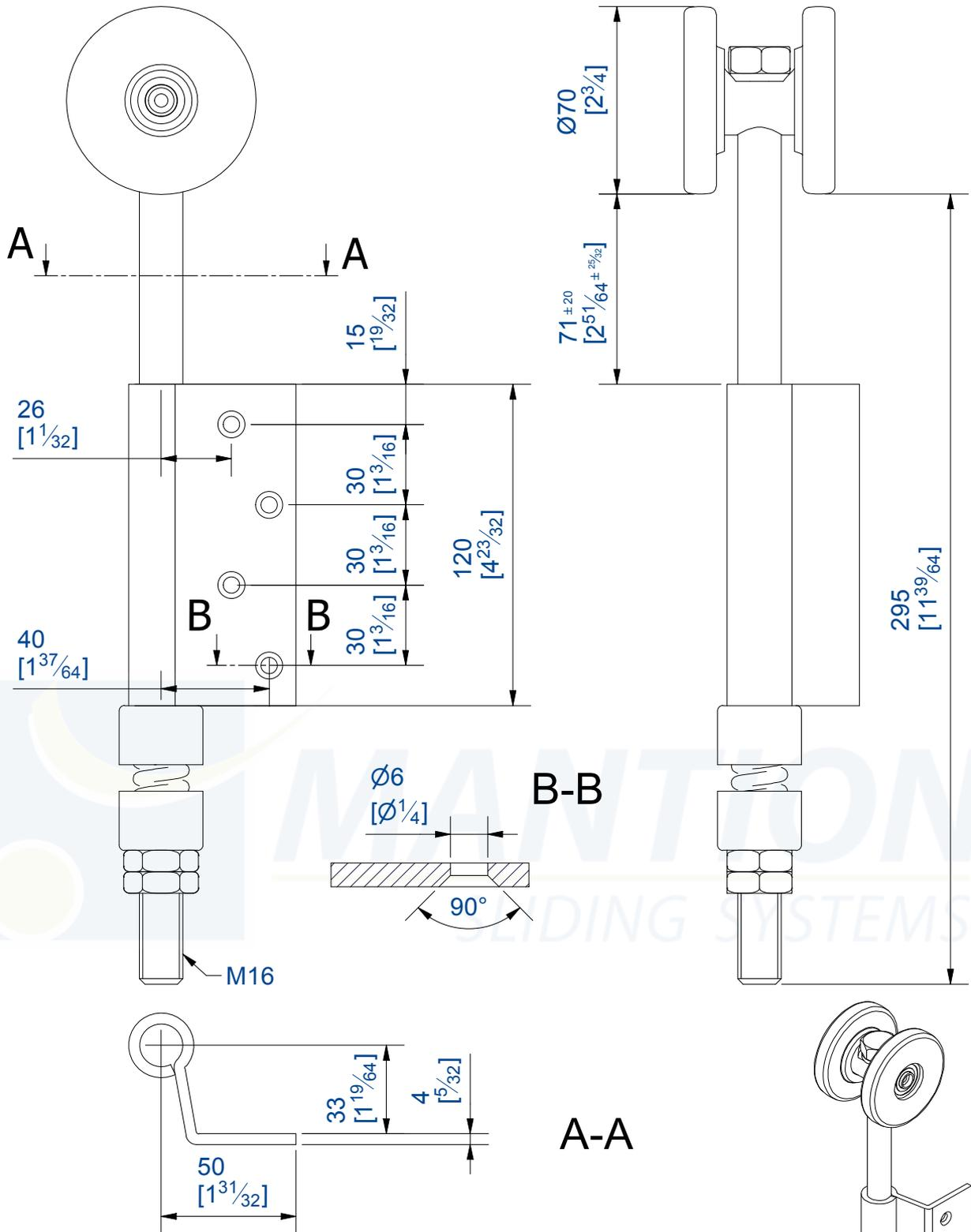
Monture d'extrémité, équipée d'une demi charnière avec 2 galets avec roulements à billes et surmoulage en nylon chargé fibre de verre. Capacité : 100 kg
