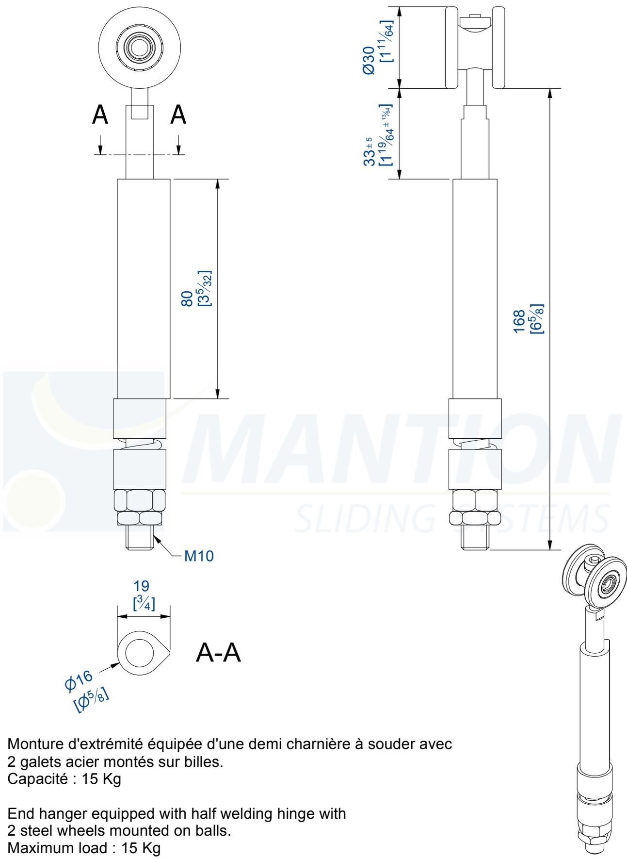
Monture d'extrémité équipée d'une demi charnière à souder avec
