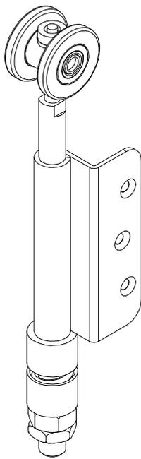
Monture d'extrémité, équipée d'une demi charnière avec 2 galets acier montés sur billes.
