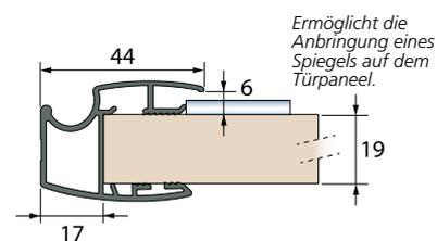
Ermöglicht die Anbringung eines Spiegels auf dem Türpaneel.
