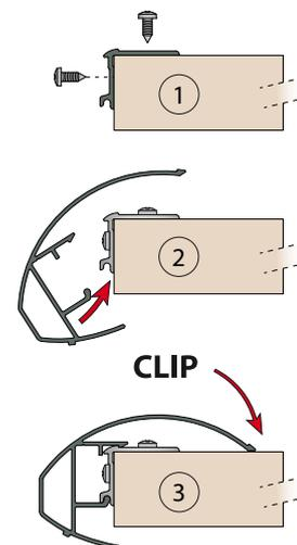
Aufklipsen der Profile in 3 Schritten: das Anbringen erfolgt durch einfaches Aufklipsen! (Beispiel mit einer Griffleiste "TROPFENFORM")
