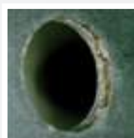
6 mois (acier galvanisé) 30-40% de rouille rouge 60% de rouille blanche
