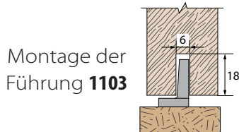
Montage der Führung 1103 mit Profil 1106
